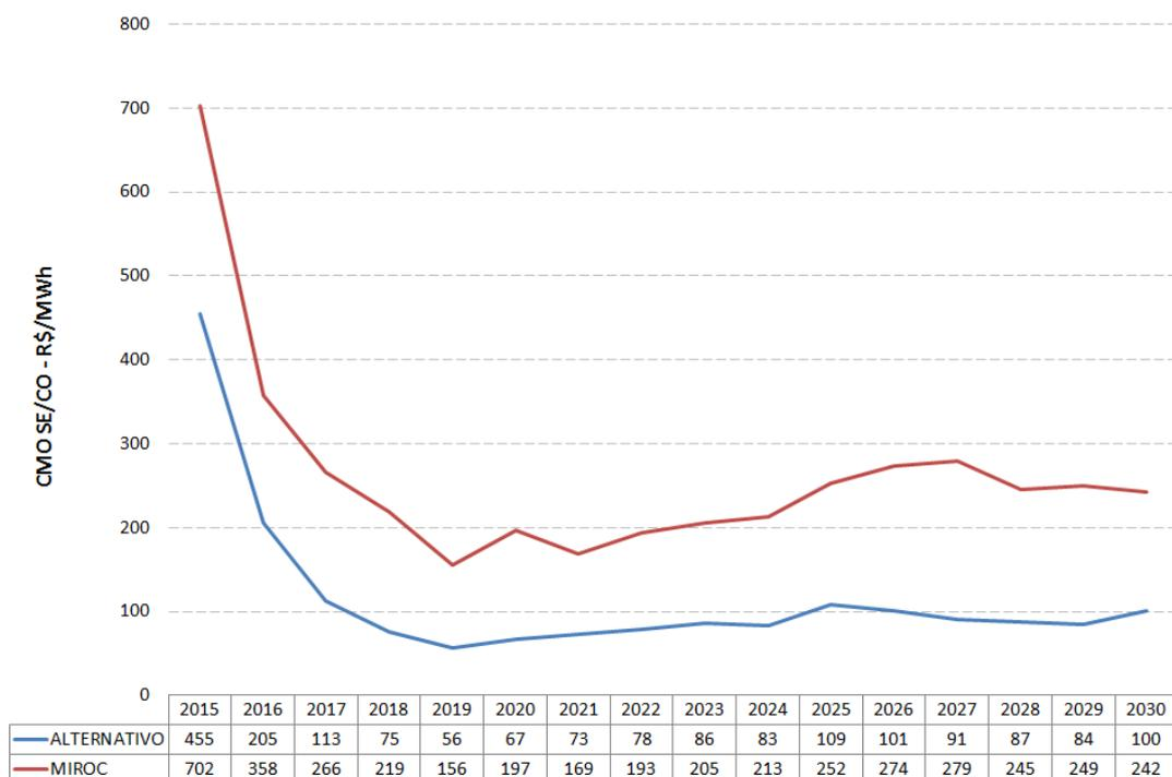
**Figura 5-13 – Custo Marginal de Operação (CMO) do subsistema SE/CO**
