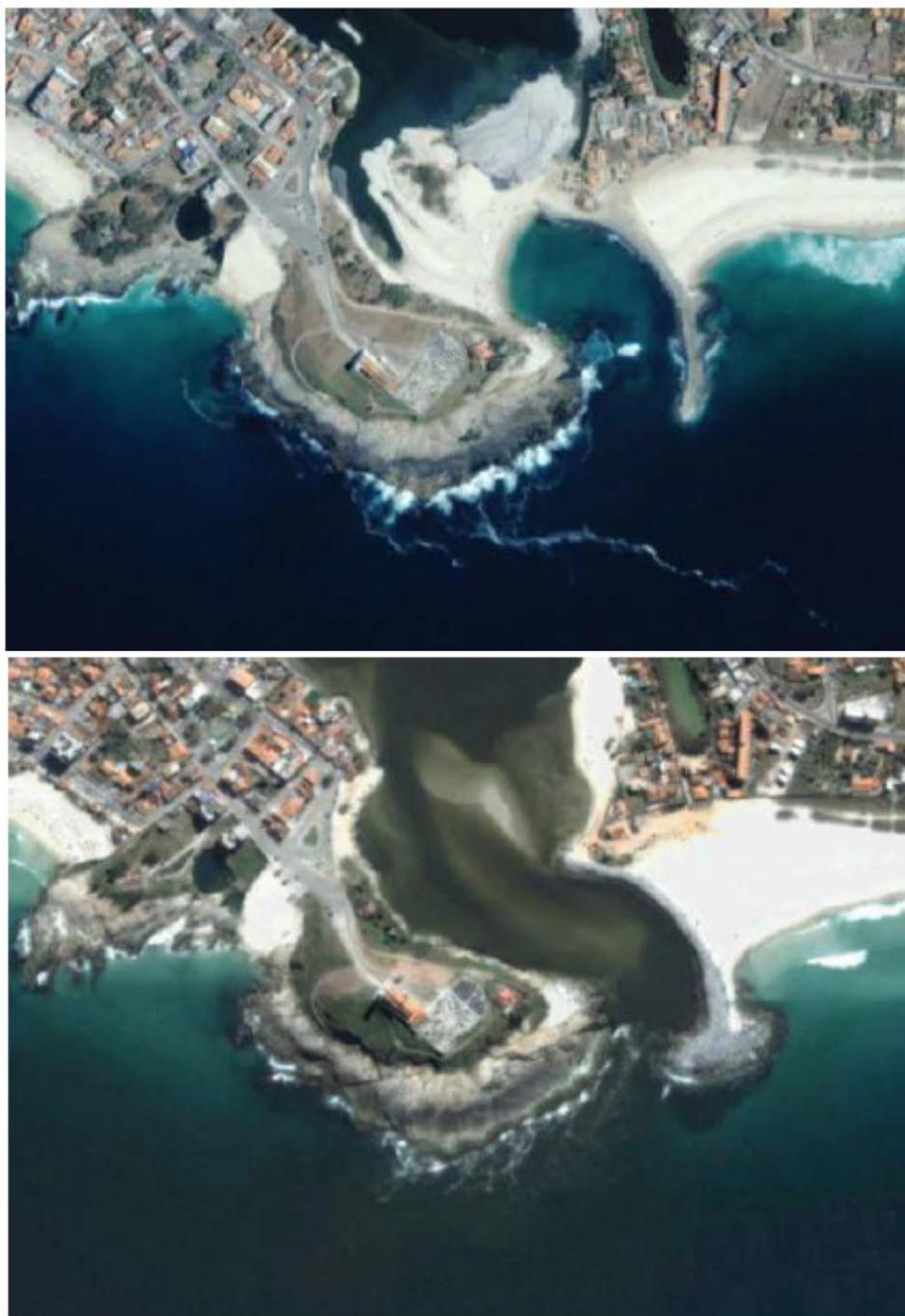
Figura 47. Colapso do enrocamento do molhe de Saquarema entre 2003 e 2005.
